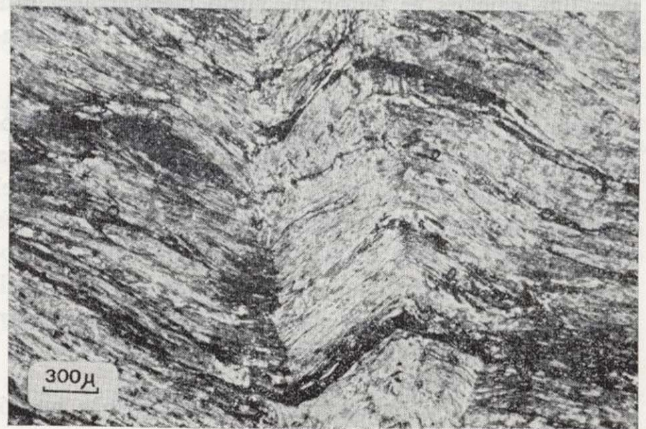
Figura 7.—Aspecto microscópico de las inclusiones de carbonatos en el talco blanco (Somontín-Lúcar). Con analizador.
